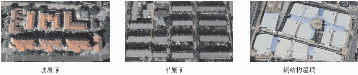
图 1 屋面类型识别标准 Fig. 1 Roof type identification criteria
